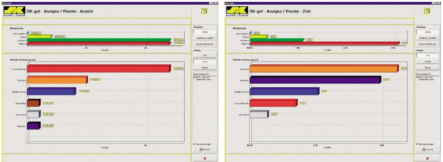
Typisch für Mikrostopps: häufig wiederkehrende Störung (links) mit relativ kurzer Gesamtstillstandszeit (rechts), wie bei Auswurfkontrolle (roter Balken).
